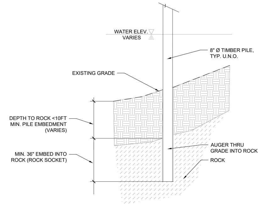
2 PILE TIP BEARING AT ROCK
