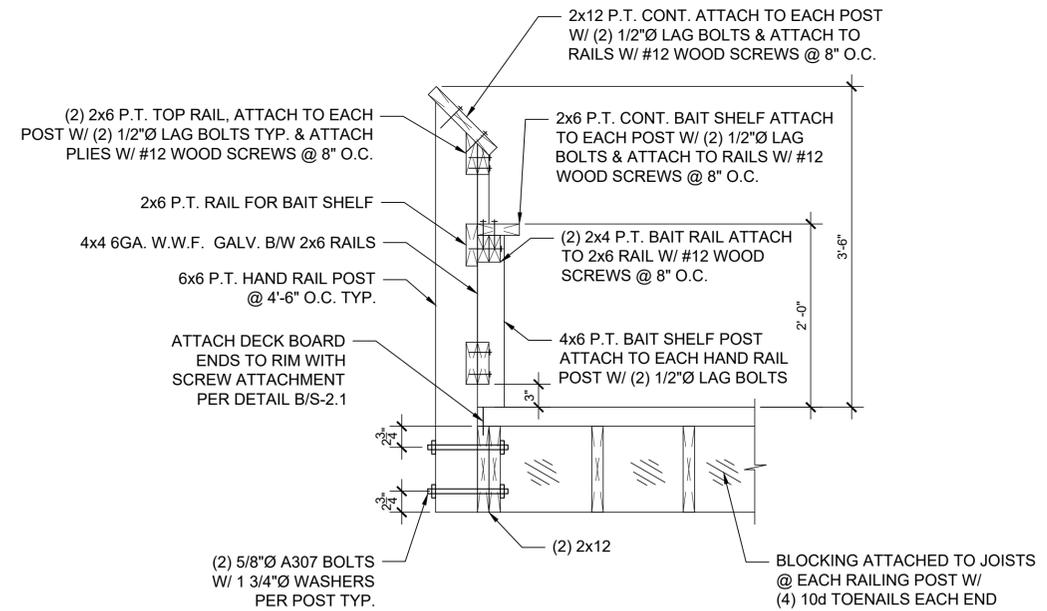
**C** FISHING RAIL DETAIL AT PIER ENDS
